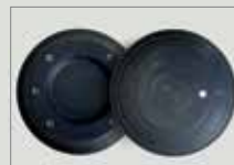
Cojines de vacío y marco modificados (Ventosas curvas)
